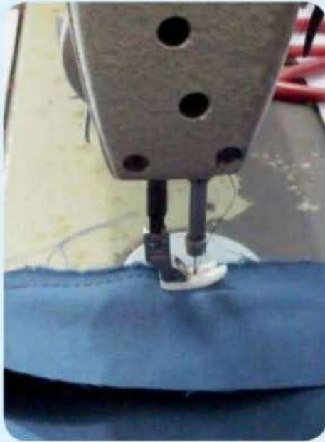
3. Jahit pola sandaran dengan pola bagian ketebalan samping.
