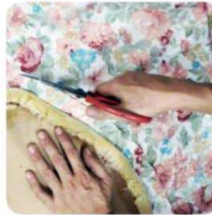
4. Buat pola untuk penutup sandaran belakang, kemudian gunting bahan sesuai pola dan rekatkan bahan dengan lem kuning. Aplikasikan lem pada pinggiran rangka kursi untuk menempelkan sandaran belakang yang sudah diganti dengan bahan baru.
