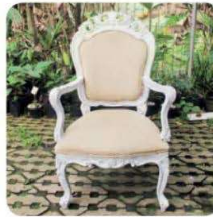
2. Lapisi permukaan furnitur dengan cat dasar berwarna putih. Warna putih akan membuat warna cat baru lebih tegas. Setelah kering benar, aplikasikan cat lapisan kedua sesuai warna yang diinginkan. Beri lapisan kedua jika lapisan pertama masih kurang memuaskan. Setelah aplikasi cat selesai, saatnya mengganti jok.
