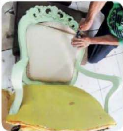
3. Lepaskan busa sandaran depan dan dudukan kursi. Tambahkan satu lapis busa baru jika kondisi busa lama sudah tidak baik.
