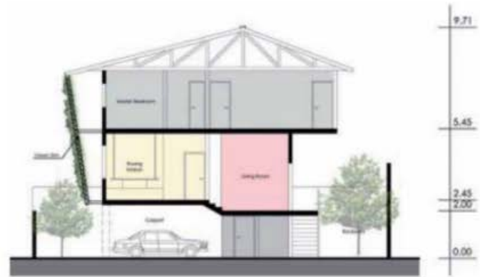
Potongan A-A Hunian dibuat dengan area berkolom di bawahnya sehingga fungsi-fungsi utama seluruhnya berada di atas.
