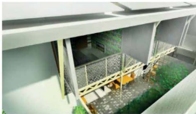
Kamar-kamar di lantai dua menggunakan dinding yang semitransparan sebagai ventilasi udara dengan bukaan menghadap taman dalam.
